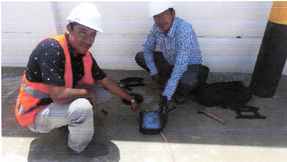
2- Vista fotográfica de mediciones de pozos a tierra como resultado son menores a 10 ohmios tal como requiere el proyecto.
